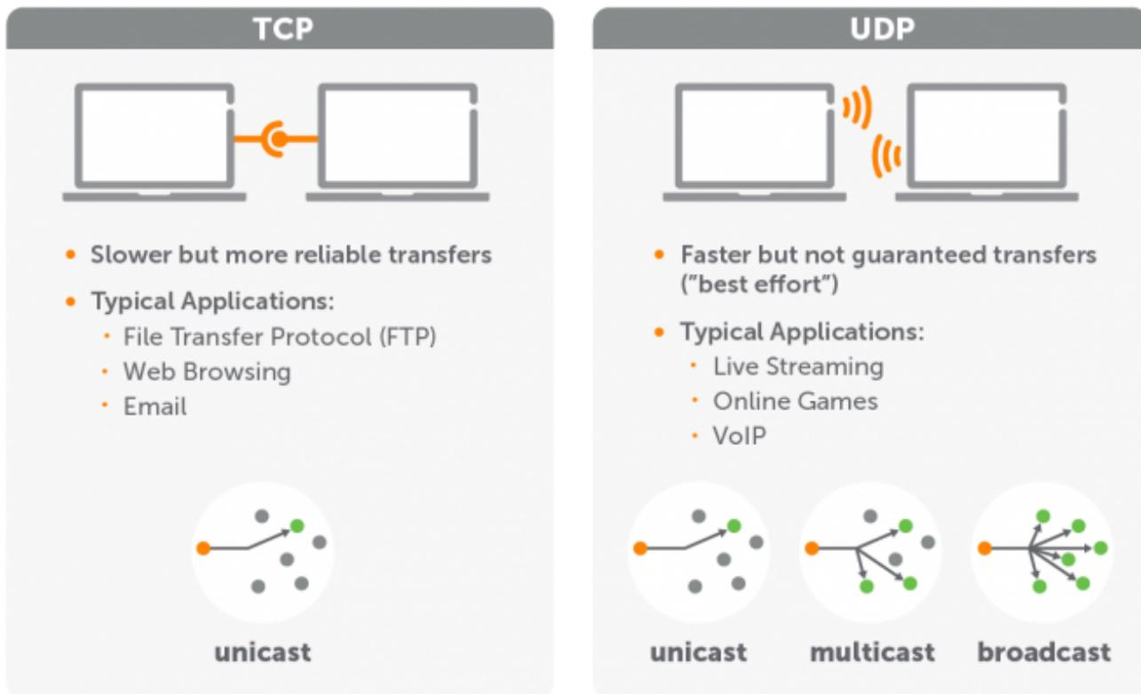
El protocolo UDP funciona de manera similar al protocolo TCP, pero no es un protocolo de transporte orientado a conexión. Esto quiere decir que el protocolo UDP no verifica la recepción de los datos transmitidos entre un dispositivo y otro. Por esto, se articula en un nivel de capa inferior al protocolo TCP, con lo que el sistema de verificación de la recepción de los datos debe implementarse en las capas superiores.
