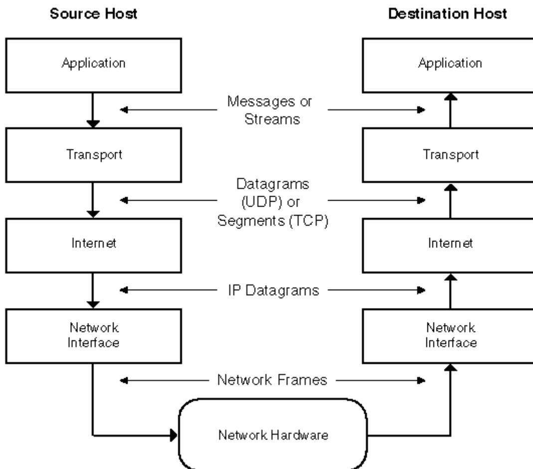
En una red, la comunicación real se realiza de una capa a la siguiente o a la anterior. Sin embargo, las aplicaciones de cada capa realizan una abstracción de las capas inferiores y ven su flujo de comunicación como una comunicación directa con la capa equivalente en el otro extremo de la conexión.
